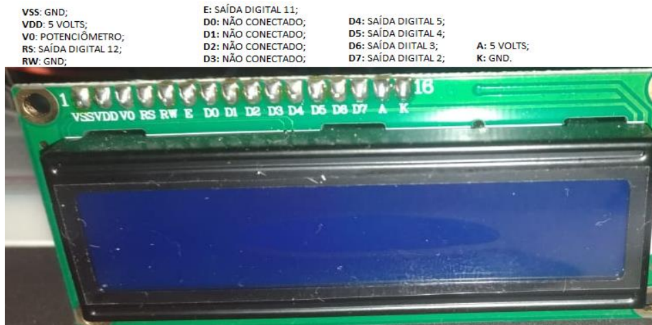
Figura 15 - Esquema de ligação do display.
